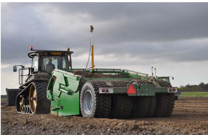
Kilveren is één van de hoofdtakken. Martens heeft onder andere deze Bos Mega Dozer draaien met een schuifblad voor op de John Deere-rups.
